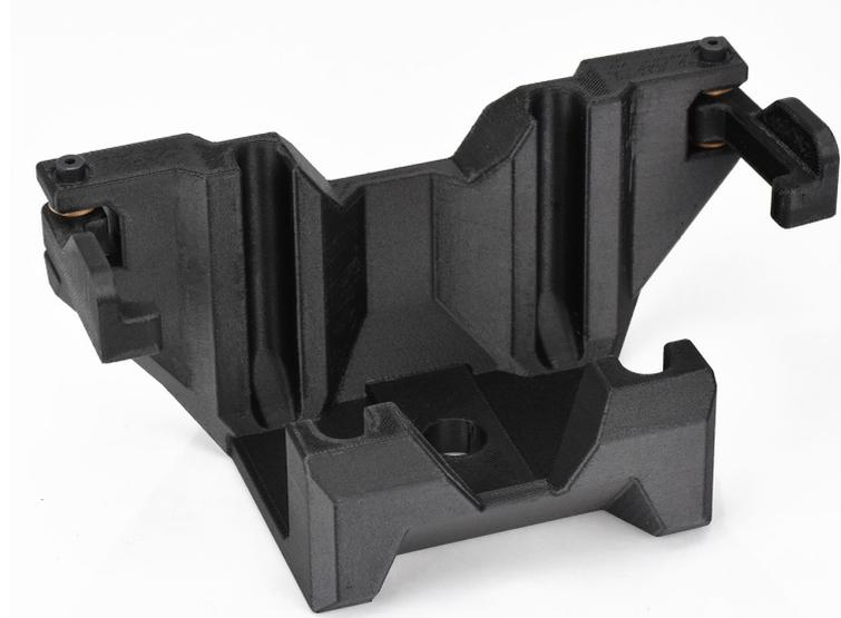
Dieses 3D-gedruckte Werkzeug aus Kohlefaser wird auf einer Montagelinie für Schwerlastkraftwagen eingesetzt, um die Schrauben für die Montage der U-Bolzenplatte der Achse genau zu positionieren.
