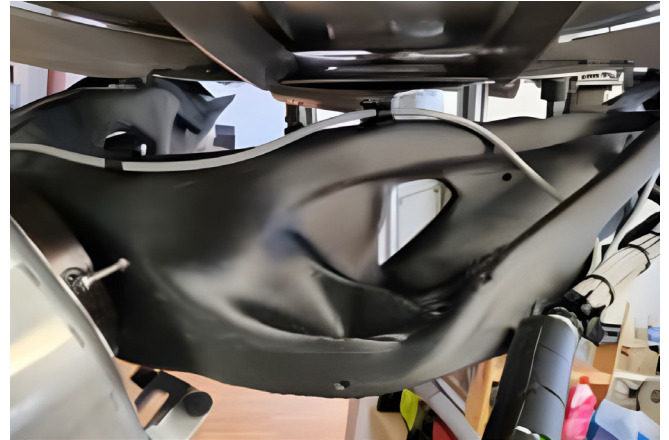
Die an der Antennenbaugruppe installierte 3D-gedruckte Halterung (schwarz) aus Nylon 12CF.
