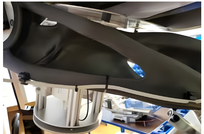
Eine weitere Ansicht der 3D-gedruckten Halterung zeigt die generativ entworfene organische Form.
